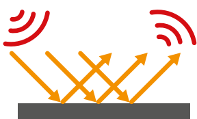
a) Schallabsorptionsgrad \alpha = 0 Keine Schallabsorption Der Schall wird vollständig reflektiert
